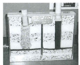
砕石パイルによる地盤強化「HySPEED工法」
